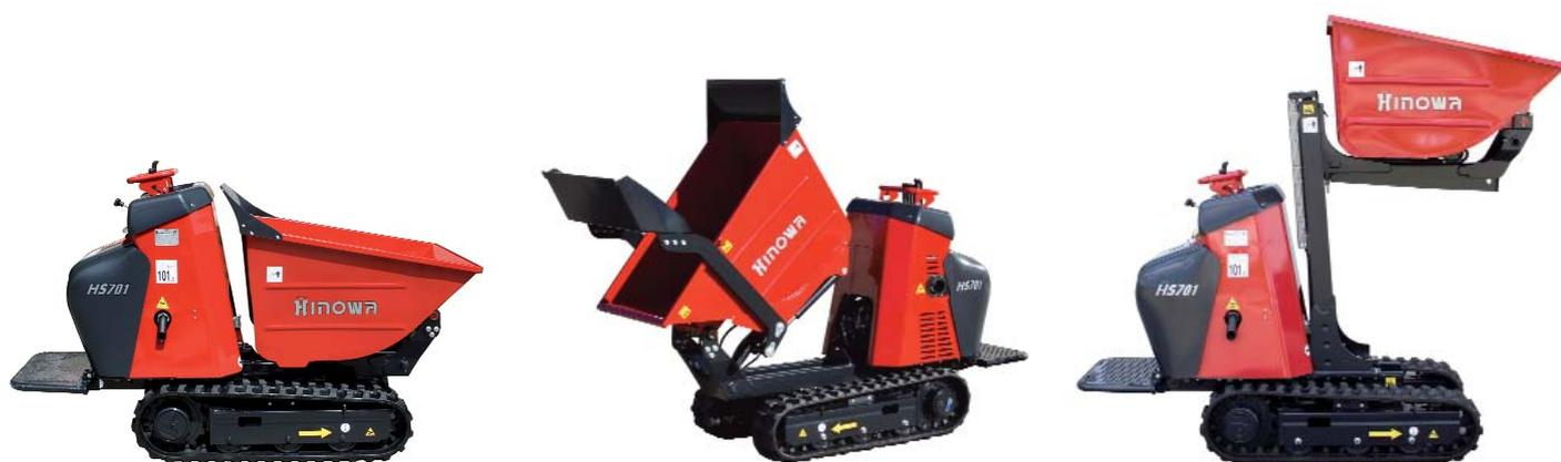
Grazie ad un sistema completamente idraulico e a comandi semplici e pratici da usare, il cingolato offre una manovrabilità e una precisione senza paragoni. Per un uso ancora più pratico, l'operatore può scegliere la velocità in base alla tipologia di terreno: più lento per una superficie sconnessa, più veloce nel caso di una superficie pianeggiante.
