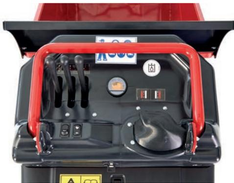
Panel de control aún más simple y seguro de usar, gracias a los joysticks ergonómicos y al botón "enable" útil para evitar que el operador realice movimientos accidentales y la posibilidad de elegir entre dos velocidades: "ecomode" en superficies sueltas y para ahorrar energía "power" en terrenos planos.
