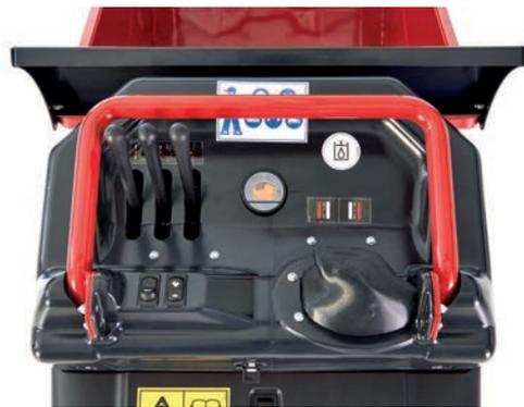
Das Bedienfeld ist dank der ergonomischen Joysticks und der Enable-Funktion noch einfacher und sicherer. Dies verhindert, dass der Bediener Bewegungen aus Versehen ausführt, und bietet die Möglichkeit, zwischen zwei Geschwindigkeiten zu wählen: "Ecomode" auf unebenem Untergrund und für einen geringeren Energieverbrauch, "Power" auf ebenem Untergrund.
