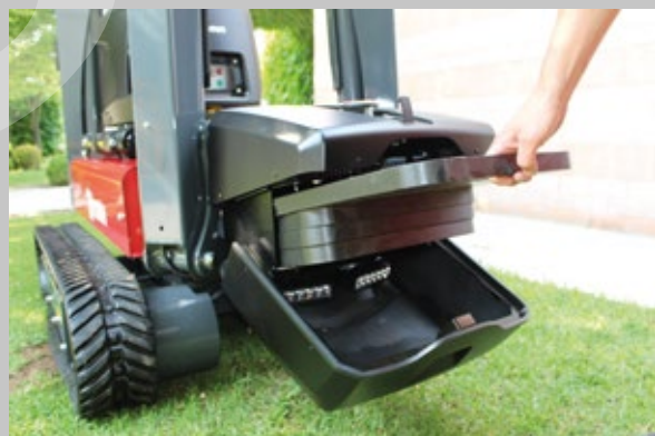
Contentore con chiave per piastre di stabilizzazione
