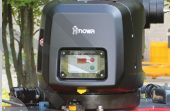
Caricabatterie e display che indica lo stato di carica della TeleCrawler13N
