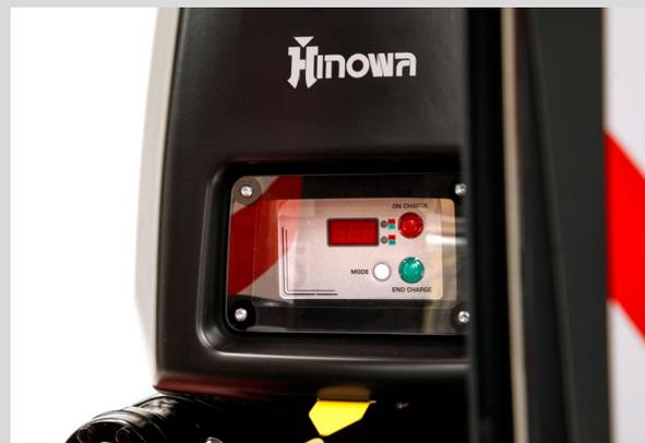
Cargador de batería y pantalla que indica el estado de carga.
