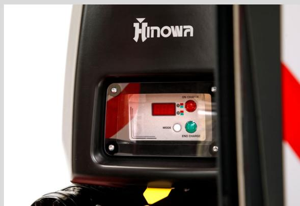
Chargeur de batterie et écran indiquant l'état de charge.
