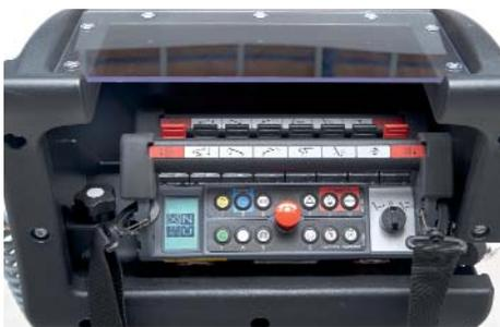
Il telecomando, nella versione Performance III S, consente agli operatori di effettuare con semplicità e disinvoltura le operazioni di auto stabilizzazione, movimentazione bracci e traslazione. Il display, con un sistema icone semplici e intuitive, mostra all'operatore le informazioni utili.
