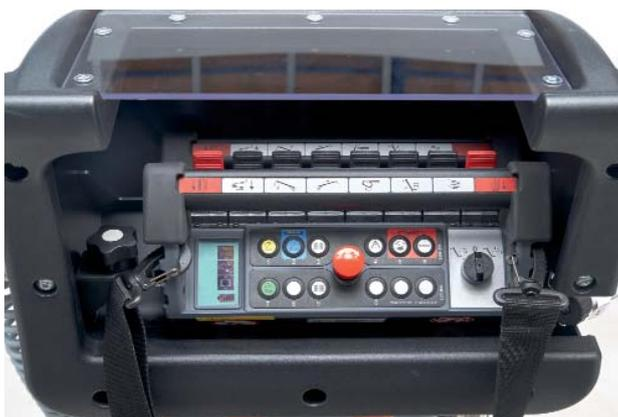
Die mit der Lithium-Ionen-Antriebseinheit ausgestatteten Maschinen verfügen über ein integriertes Diagnosesystem, anhand dessen der Bediener etwaige Störungen feststellen und die wichtigsten Betriebsparameter des Akkupacks direkt am Fernbedienungsdisplay überwachen kann. Der Bediener wird zunächst über ein Symbol und ein Akustiksignal, dann anhand der allmählichen Verlangsamung der Maschinenbewegungen darauf hingewiesen, dass die Ladung sich dem Aufbrauch nähert. Im Falle einer Störung
