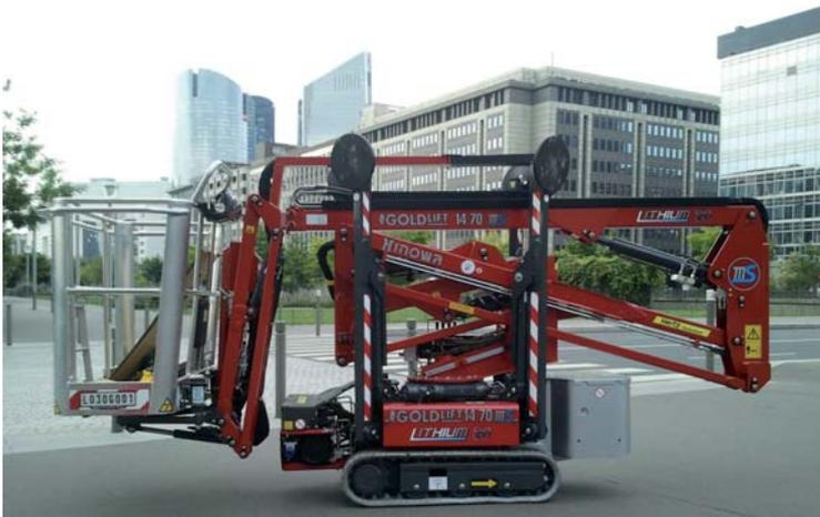
gegeben ist und Maschinen mit Verbrennungsmotor keinen Zugang haben. Während des Betriebs werden keine schädlichen Gase ausgestoßen und bei der Aufladung des Lithium-Ionen-Akkupacks keine Säuren abgegeben, daher besteht keine Gefahr, dass der Raum mit gefährlichen Dämpfen und Stoffen gesättigt wird.
