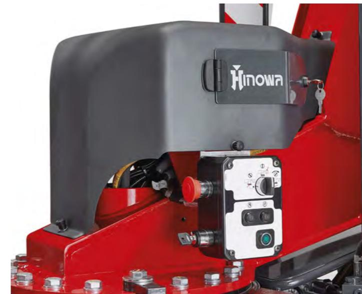
Boîtier avec clé de contact et bouton d'arrêt d'urgence.
