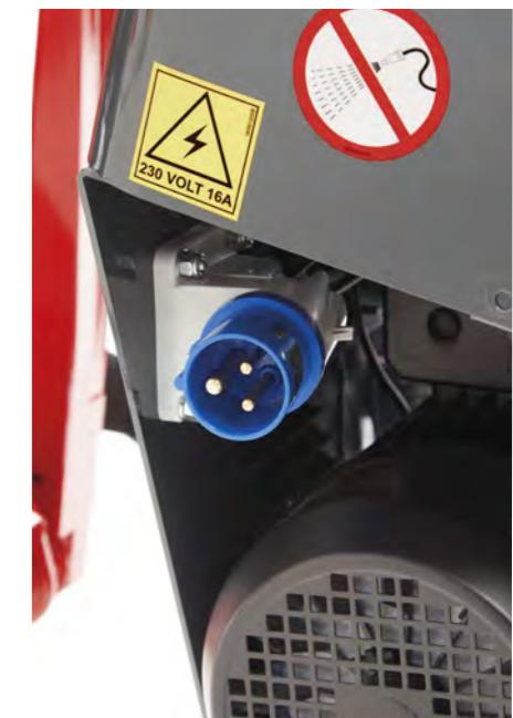
**Prise pour moteur électrique** et pour recharger l'éventuel paquet de batteries au lithium.
