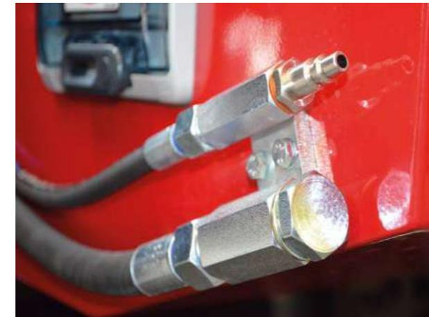
**Linea ausiliaria Ø1/4" al cesto standard per permettere l'uso di diverse attrezzature da lavoro per es. ad aria.**
