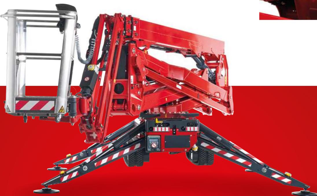
**Rotazione del cesto 124° (+/- 62°)**, stabilizzazione e chiusura stabilizzatori automatica IIIS.
