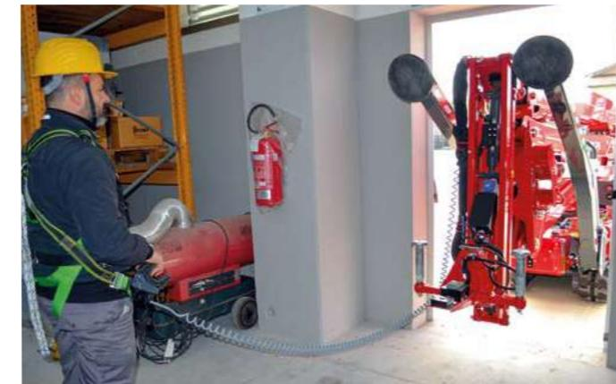
Sottocarro che permette una maggior stabilità, un migliore angolo di attacco e la riduzione della pressione al suolo in fase di traslazione.
