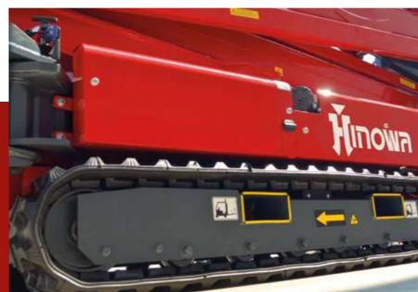
**Pratico alloggiamento per forche muletto o telehandler** per il sollevamento, carico, scarico e trasporto della macchina.
