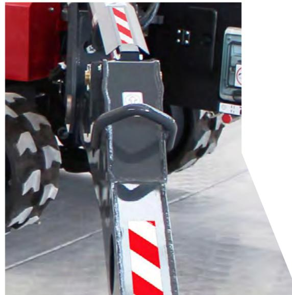
**Ganchi di sollevamento** su stabilizzatori Heavy Duty per posizionamento con gru da cantiere.
