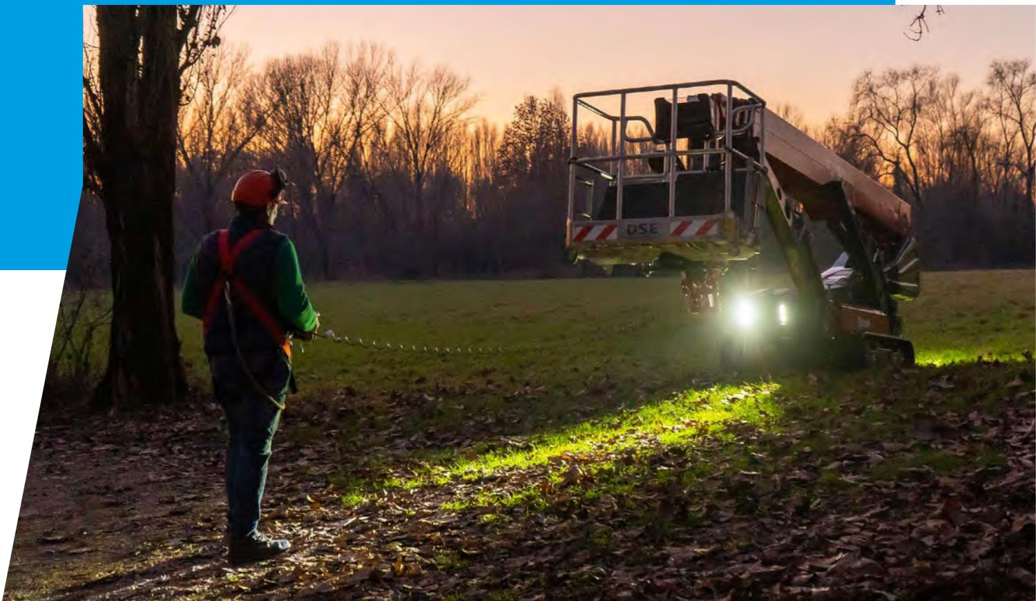
**Fari di lavoro a LED anteriori e posteriori.** *Luces de trabajo LED delanteras y traseras.*
