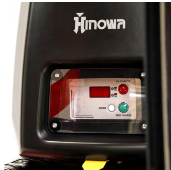
Battery charger and display indicating the remaining charge. Akkuladegerät und Display mit Ladeanzeige..
