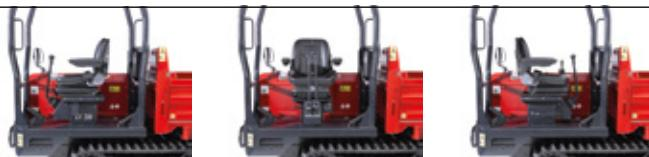
Le siège très confortable peut tourner de 180° pour permettre de commander la machine avec une bonne visibilité dans les deux directions de marche.
