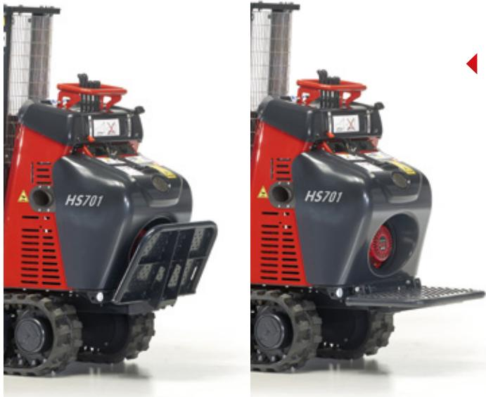
Les minidumper Hinowa ont une plateforme repliable ce qui permet à l'utilisateur de monter et descendre facilement de la machine, et aussi en refermant la plateforme ça réduit la longueur pour le transport ou le stockage de la machine.
