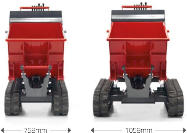
Le minidumper est aussi équipé en option d'une voie variable hydraulique de 758-1058 mm qui permet de passer facilement une porte standard, et d'augmenter la stabilité avec la voie élargie.
