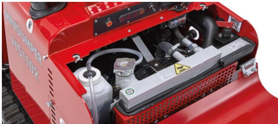
Son nouveau capot est réalisé pour permettre un accès très simple de tout les composants ainsi que du moteur thermique.
