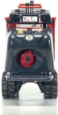
◀ C'est une machine bien compacte avec une largeur de seulement 758 mm qui permet de traverser facilement les passages étroits comme les portes et portails.
