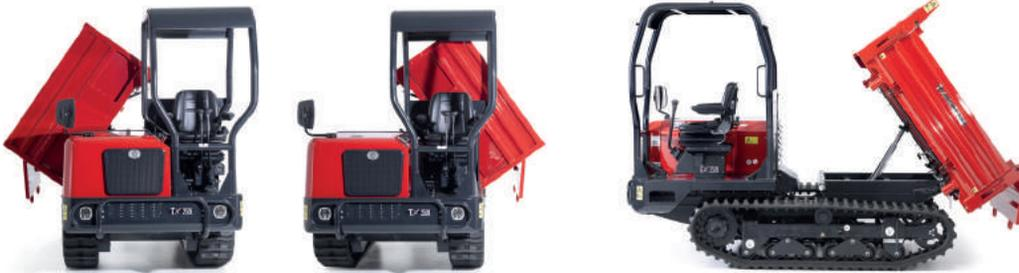
Grasse a son design et ces galets à triple bride permettent au TX 2500 d'avancer en toute sécurité sur des pentes et des terrains accidentés en diminuant les risques de basculement. Le déplacement se fait avec fluidité et un confort optimal.
