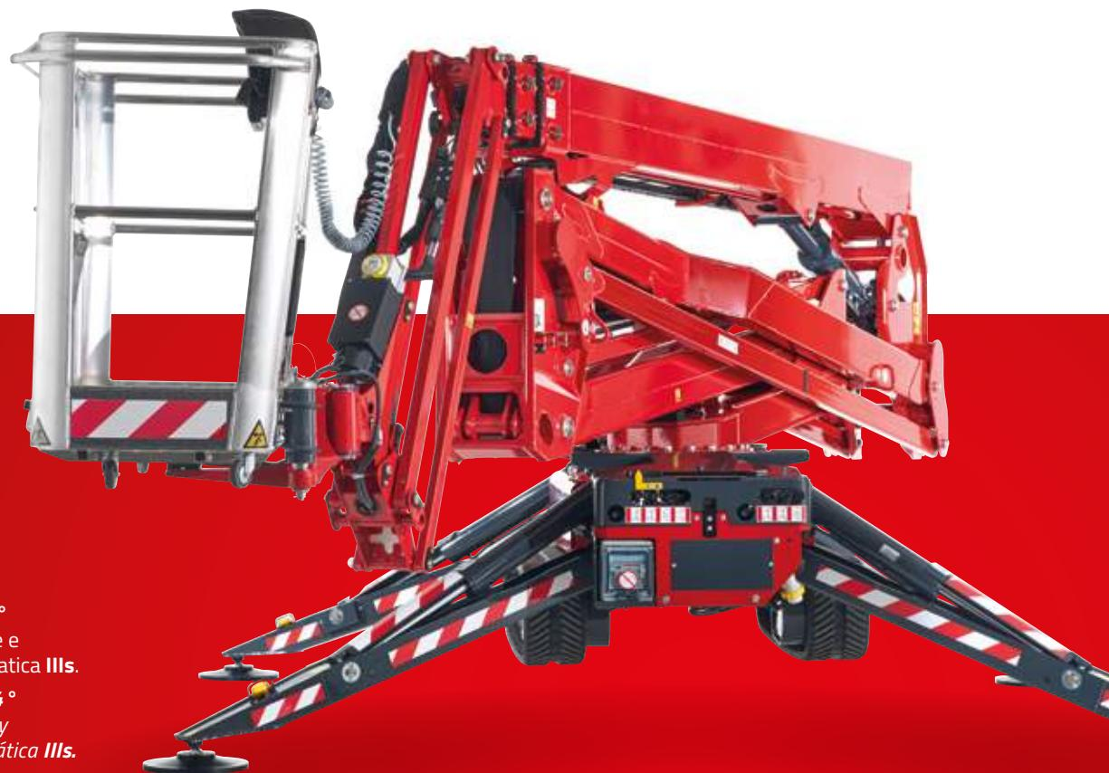
Rotazione del cesto **124°** (+/- 62°), stabilizzazione e destabilizzazione automatica **III****S**.
