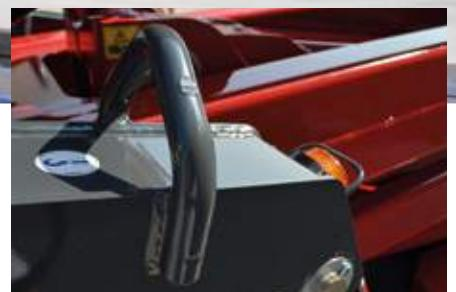
**Ganci di sollevamento** su stabilizzatori Heavy Duty per posizionamento con gru da cantiere.
