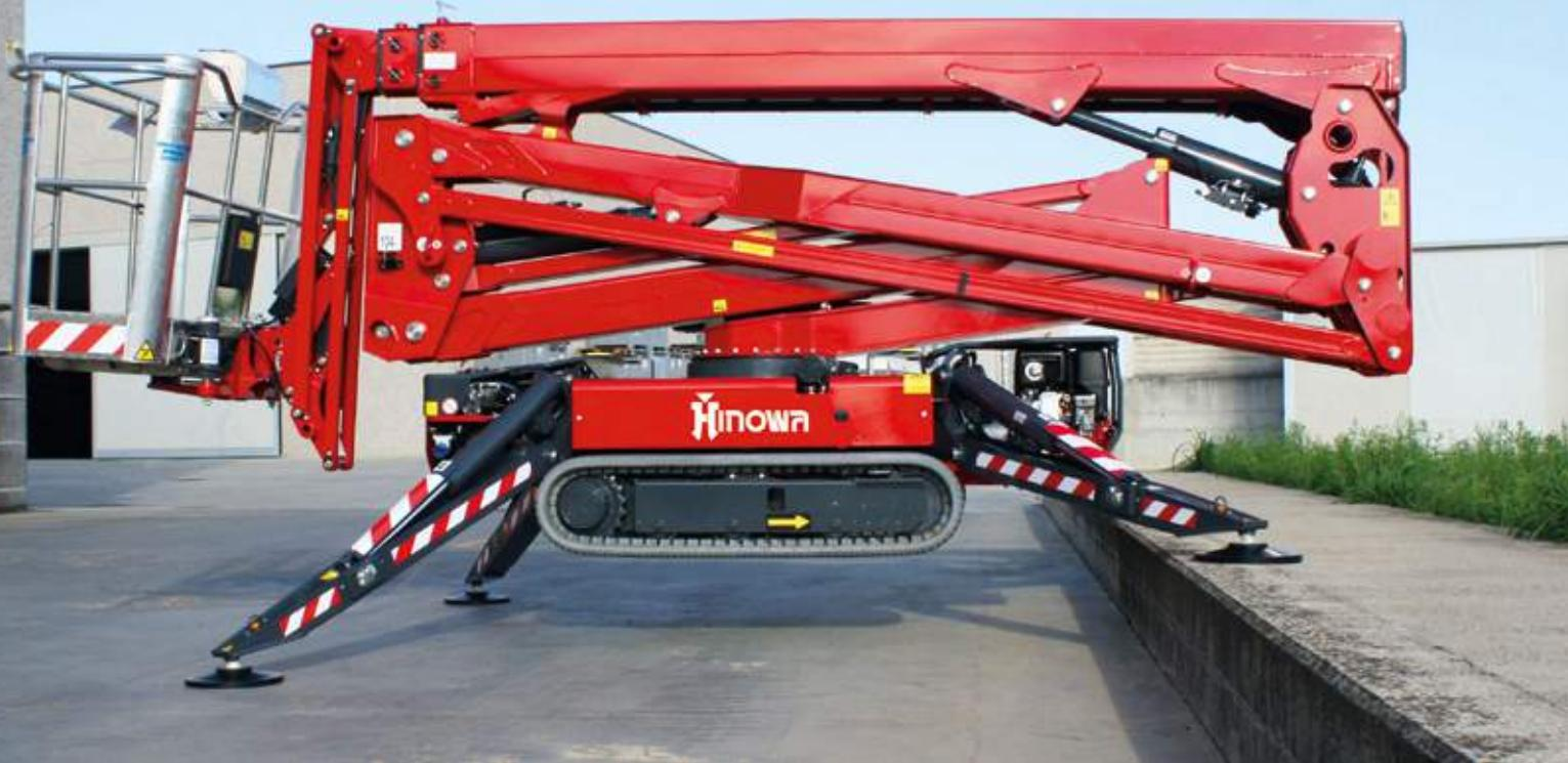
**Stabilizzazione automatica assistita su pendenze fino a 16°.** Permette una luce al suolo di ben 700 mm (solo su modello Lightlift 26.14) a macchina completamente stabilizzata con controllo della pendenza in destabilizzazione.
