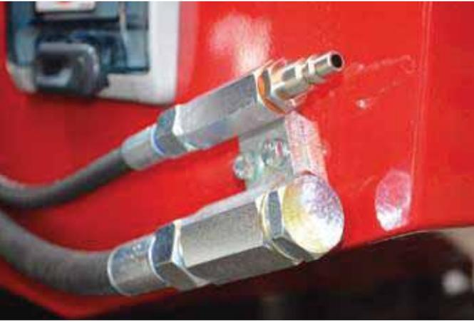
▼ **Linea ausiliaria Ø1/4" al cesto standard per permettere l'uso di diverse attrezzature da lavoro per es. ad aria.**
