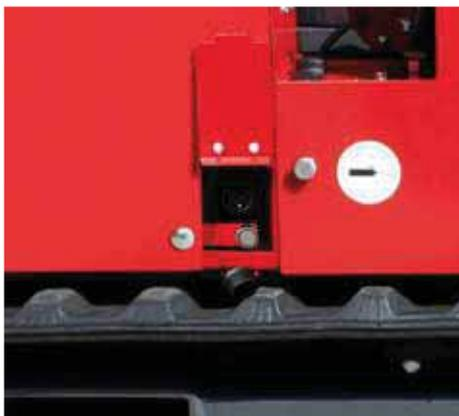
▼ **Connettore ausiliario** per apparati esterni per telematica e tracking flotta.
