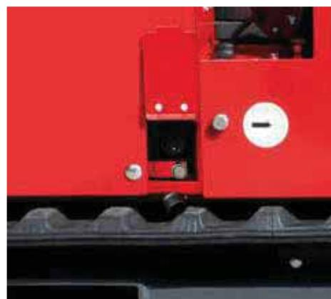
**Connecteur auxiliaire** pour les appareils extérieurs pour la télématique et la localisation de la flotte.
