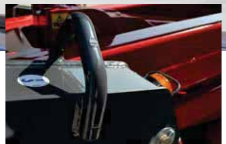
**Crochets de levage** sur les stabilisateurs
