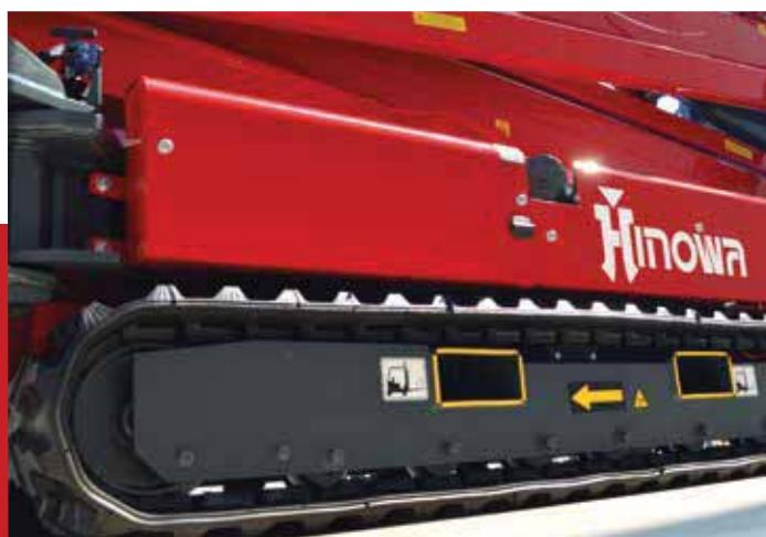
**Logement pour fourches chariot élévateur ou telehandler** pour le levage, chargement, déchargement et transport de la machine.
