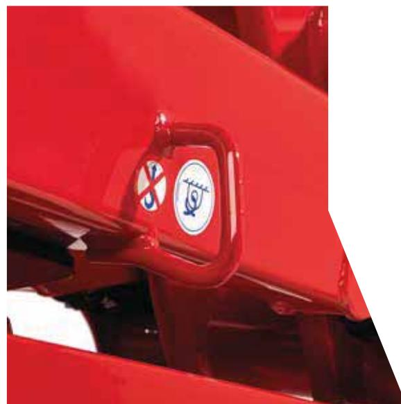
**Crochets d'ancrage Heavy Duty.**
