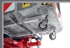
Preinstalación para sistema antiatrapamiento: es un dispositivo de seguridad y protección adicional para el operador en la cesta.
