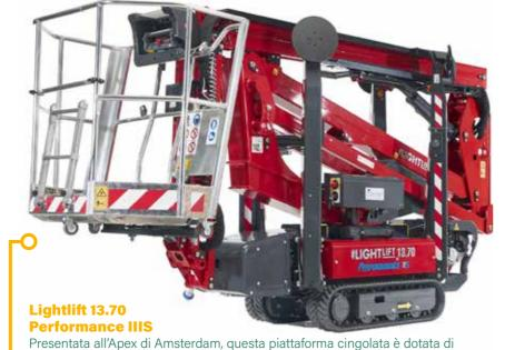
un sistema elettrico a 3,6 kW/h alimentato dal pacco batterie agli ioni di litio. Quest'ultimo garantisce zero emissioni e prestazioni elevate in termini di autonomia, silenziosità e impatto ambientale
