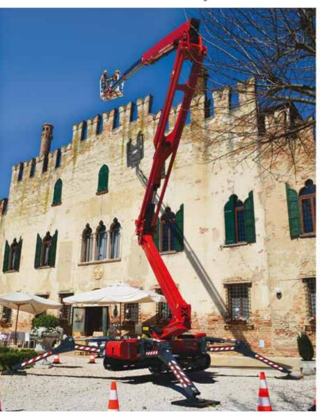
ra gli highlights della nuova piattaforma, l'altezza di lavoro di 25,7 metri e lo sbraccio di 13,6 metri, con portata unica a 230 chilogrammi per tutto il diagramma di lavoro; prestazioni eccezionali racchiuse in una macchina compatta, dalla larghezza di soli 990 millimetri (estendibile del 50% fino a 1.490 mm, per una migliore stabilità laterale) e di lunghezza inferiore ai 6 metri, grazie al cesto removibile.
