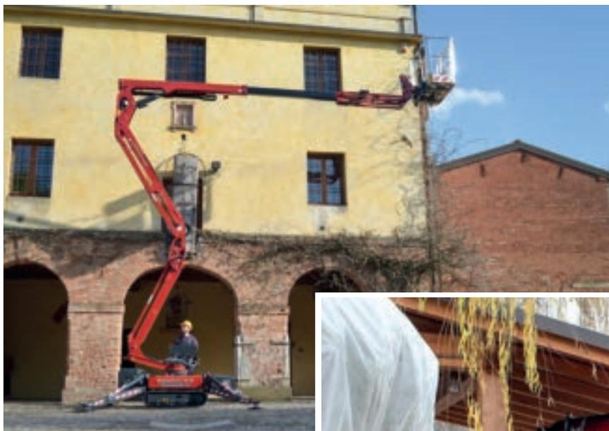
accade per l'intera nuova generazione di piattaforme Hinowa, anche la LightLift 13.70 è disponibile nella versione Lithium con pacco di batterie al litio da 3,6 kW e caricabatterie a bordo. Con sistema di ricarica rapida (80% in due ore) in modalità plug-in, questa unità sostituisce sia il motore termico sia quello elettrico, e consente di lavorare anche in assenza di collegamento alla rete elettrica. Il tutto per la massima versatilità operativa ab-
