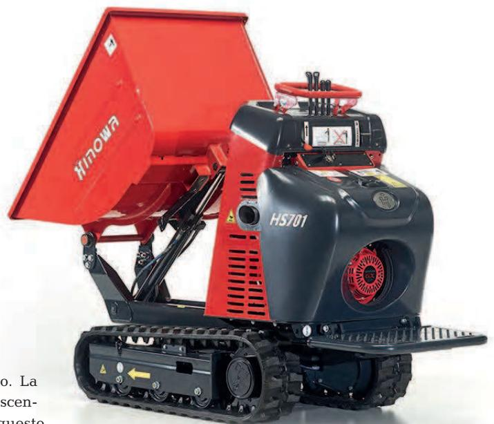
sceita dell'operatore che può adeguarla al tipo di terreno da affrontare, mentre la pendenza superabile varia da 20° a 15° nella versione a scarico alto per ovvi motivi di stabilità legati alla mag-
