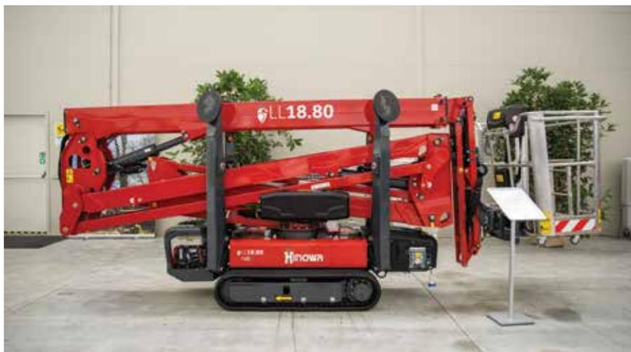
Sulla versione MK2 è stata inoltre implementata la pratica funzione "Go Home" di Hinowa, che consente di chiudere e allineare il braccio telescopico automaticamente e in sicurezza, per portare la macchina alla posizione di trasporto utilizzando un solo pulsante.
