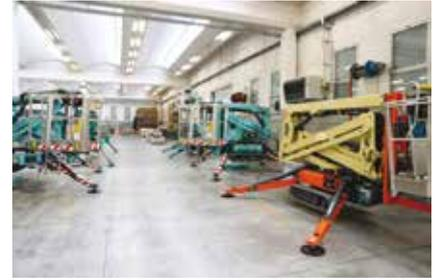
ALL'INTERNO DELLO STABILIMENTO PRODUTTIVO HINOWA L'ASSEMBLAGGIO DELLE PIATTAFORME AEREE È ESEGUITO SEGUENDO LA FILOSOFIA DELLA "LEAN PRODUCTION": L'AZIENDA NON PRODUCE SOLO MODELLI PROPRI, MA ANCHE PER CONTO DELL'AMERICANA JLG
