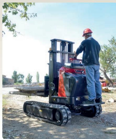
sità, il motore Kubota D902-E3B a 4 tempi, raffreddato a liquido, Stage V, da 16,1 kW (21,6 HP) a 3200 giri/min; la pompa idraulica a ingranaggi da 15 l/min di portata; impianto idraulico di ultima generazione.
