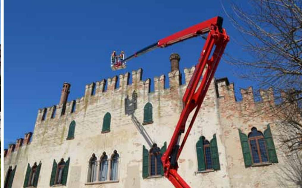
zatori a LED a basso consumo; impianto elettrico ed idraulico sezionato per semplificare il service; impianto elettrico di tipo auto motive; motore elettrico 110V-220V con coppia migliorata; possibilità di installazione dell' ultima versione software via remoto.
