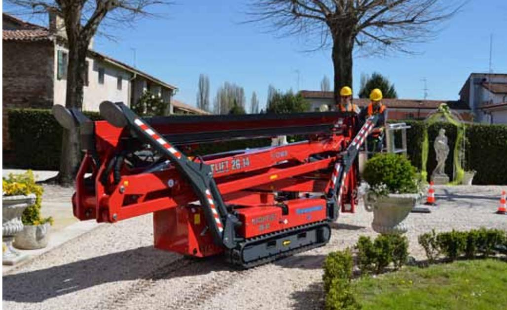
ghezza inferiore ai 6 metri grazie al cesto removibile. L'altezza di trasporto inferiore a 2 metri permette un agevole passaggio dalle porte. Ha un braccio articolato con doppio telescopico in acciaio alto-resistenziale e un'area di stabilizzazione variabile e compatta. La piattaforma è dotata di tecnologia Auto-
