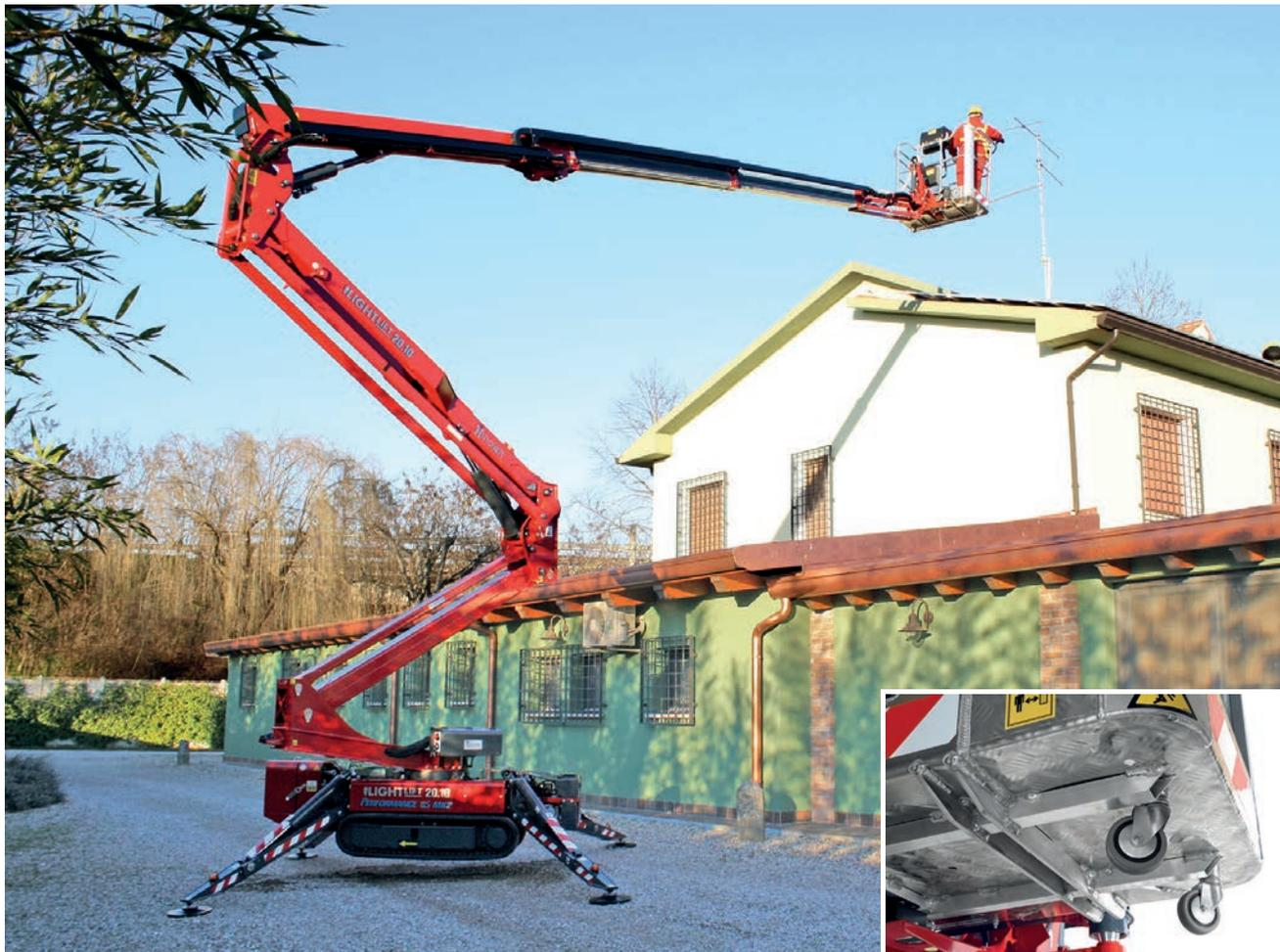
porta persone di nuova concezione con nuovo alloggiamento per il telecomando in materiale composito, con set di ruote per il trasporto quando smontato; sistema di avviamento tramite una singola chiave; e nuove luci di stabilizzazione al led. Le macchine vedranno anche la predisposizione per il sistema anti-entrapment, un dispositivo di sicurezza
