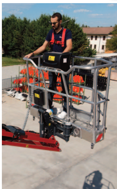
Il nuovo cesto DSE (dual side entry) della TC13S misura 1.480x610x1.100 mm
