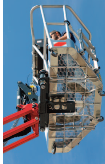
Il nuovo cesto DSE (dual side entry) della TC13S misura 1.480x610x1.100 mm
