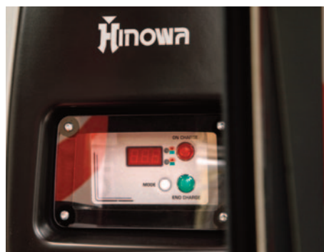
Display che indica lo stato di carica
