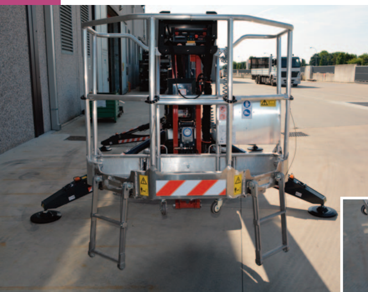
Il nuovo cesto DSE (dual side entry) della TC13S misura 1.480x610x1.100 mm
